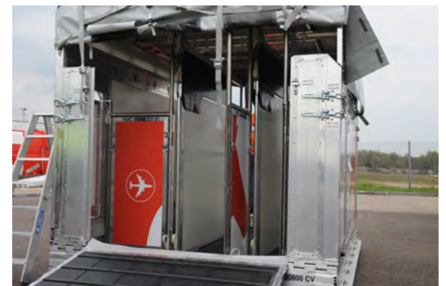
Airboxes: stallen waarin de paarden staan tijdens de vlucht. Airboxes: écuries dans lesquelles les chevaux se trouvent lors du vol.
